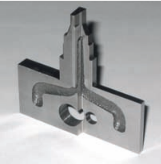
Querschnitt durch einen Werkzeugeinsatz, der per DMLS-Verfahren mit Werkzeugstahl hergestellt wurde. Das Werkzeug dient zur Produktion von Sanitärerzeugnissen und verfügt über konturnahe Kühlkanäle.
