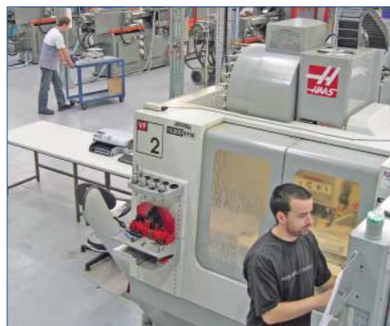
Maschinenhalle: Haas-CNC-Vertikalbearbeitungszentren und Spritzgussmaschinen.
